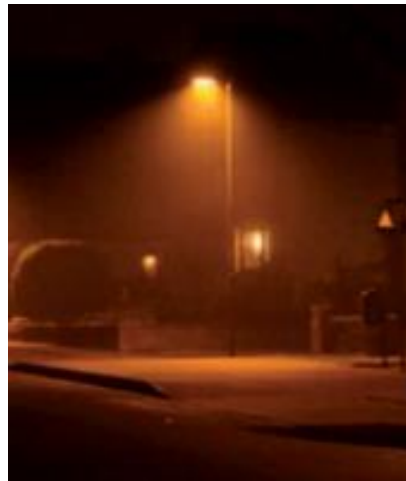
Abbildung 4 – Beispiel einer optimalen Beleuchtung mit abgeschirmten Leuchten. Beleuchten nur die Straße und blenden nicht.
